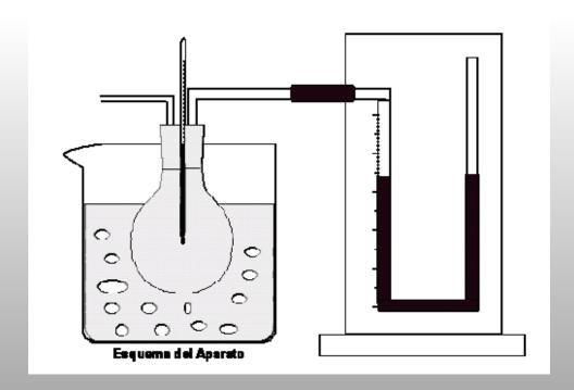
7.- Al introducir el matraz en el baño se incrementa la temperatura del aire contenido en el interior provocando su expansión y la salida de aire por el extremo abierto.
