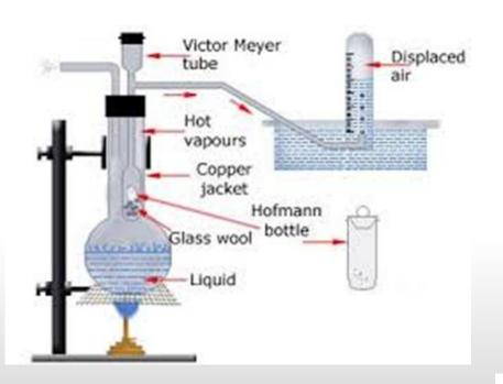
Se pesa el líquido en una ampolleta de vidrio, después se vaporiza y se determina el volumen a una temperatura y presión barométrica definidas. Finalmente, el peso molecular se obtiene sustituyendo estos valores en la ecuación:
