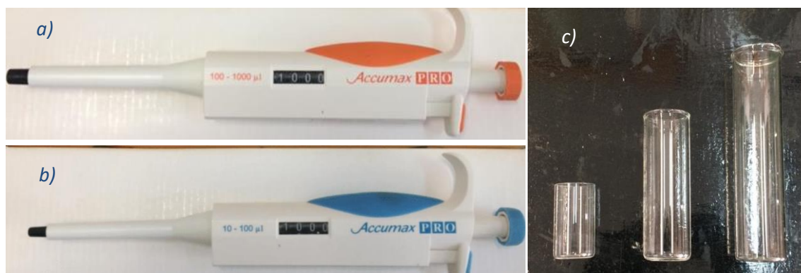
Figura 3. 2. a) Pipeta Accumax PRO® (100-1000) \mu\text{L} , b) Pipeta Accumax PRO® (10-100) \mu\text{L} , c) Celdas de vidrio empleadas para contener el volumen de los procesos de valoración.
