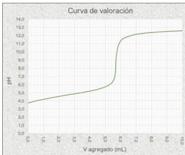
Figura 4. 8. Electrodo Scholar Corning 420. Registro típico para la curva de titulación de una alícuota de la disolución de KHBf realizando adiciones de la disolución de NaOH , pH vs V_{agregado} .
