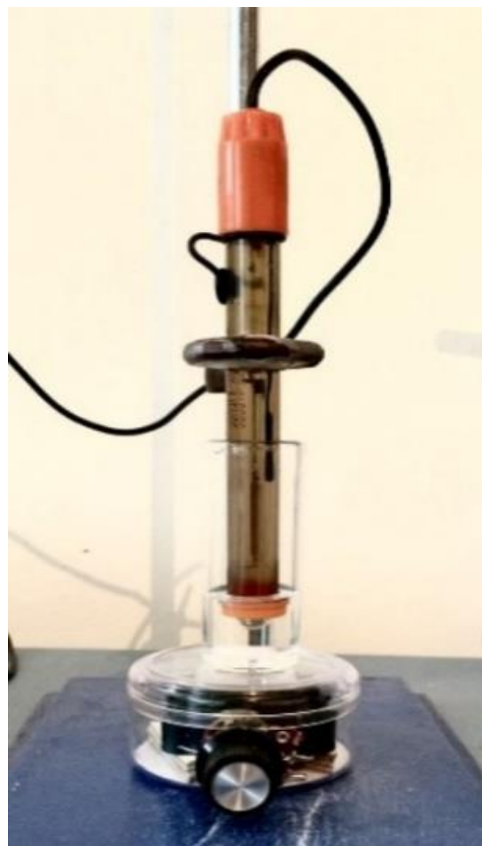
Figura 3. 7. Celda de trabajo montada para llevar a cabo los procesos de valoración.
