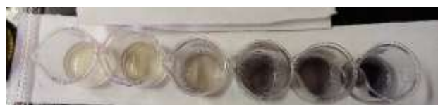
Figura 3. Desarrollo de color de los puntos de calibración para la construcción de la curva con los diferentes niveles de concentración de la solución de Fe^{3+} .
