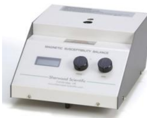
Fig. 1b Balanza magnética a emplear en la práctica.
