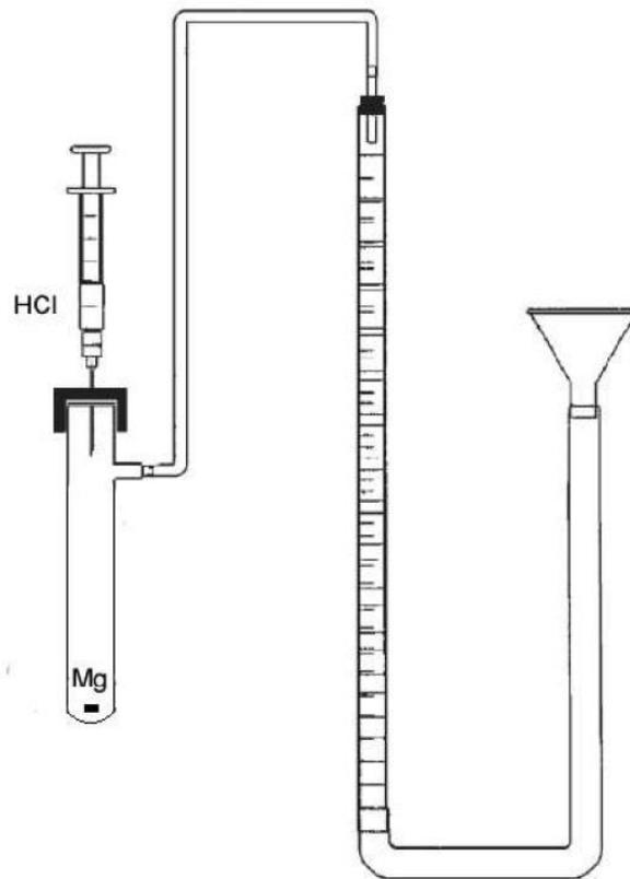
**Figura 1. Aparato de Recolector de Gases**
