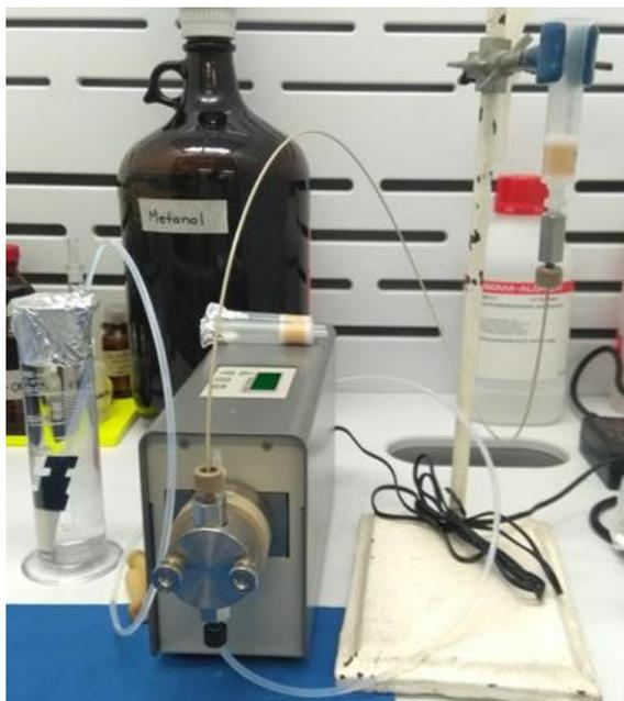
Fig. 3.1. Sistema de extracción en fase sólida (EFS) utilizando una bomba auxiliar de HPLC.
