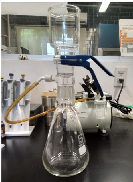
Fig. 3.5. Sistema de filtración con una membrana de poliamida de  $0.45\ \mu\text{m}$
