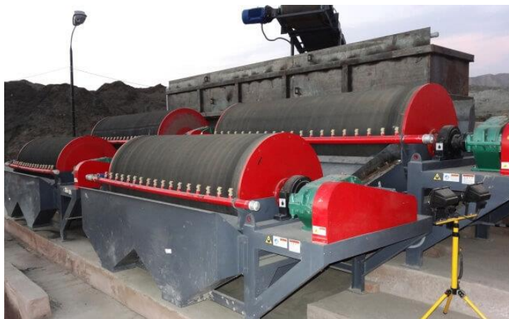
Figura 2.- Fotografía de un grupo de separadores magnéticos usados en un proceso de beneficio de minerales.
