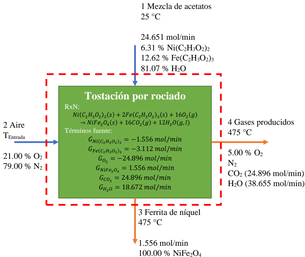
Figura 3.- Datos conocidos del proceso de producción de ferrita de níquel mediante tostación por rociado.
