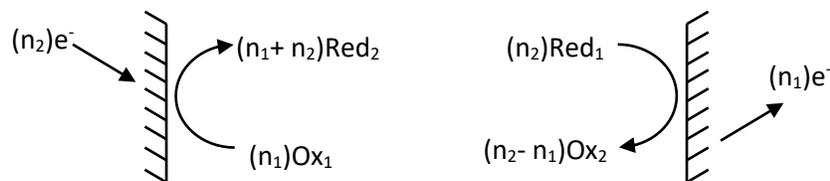
**Figura 4.3** Representación esquemática de las reacciones que acontecen al electrodo. Izquierda, una electroreducción en el cátodo cargado negativamente. Derecha, una electrooxidación en el ánodo, cargado positivamente. Centro, medio conductor.
