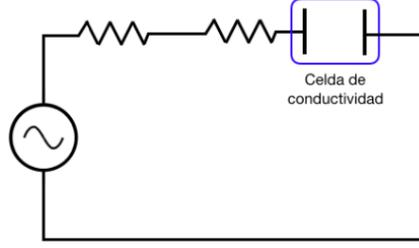
Figura 1: Diagrama del circuito eléctrico con una celda de conductividad
