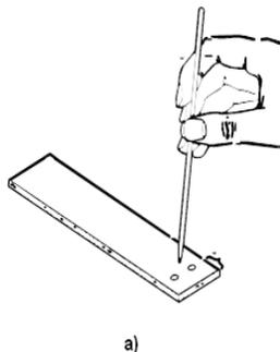
**Figura 4. a)** Aplicación de la muestra en la cromatoplasma
