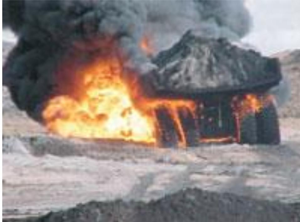
**Los sistemas de supresión de fuego pueden llegar a reducir el riesgo de fuego en las llantas de los camiones y en algunas minas se llegan a usar sprays de agua para reducir las temperaturas de las llantas, al transportar la carga en distancias grandes**
