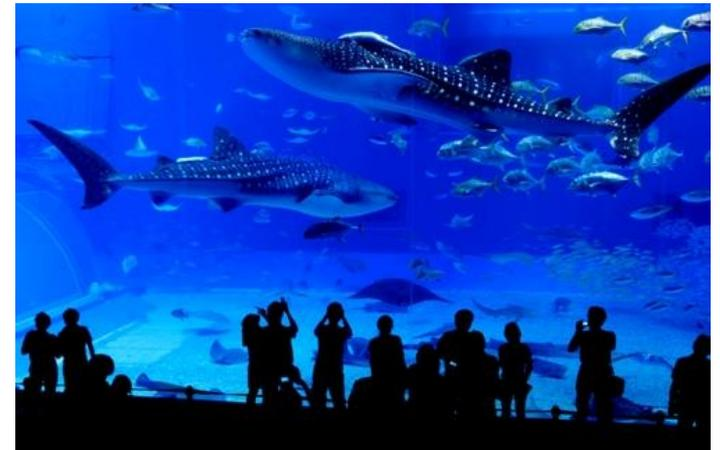
**La ventana más grande del mundo, una ventana panorámica en el acuario de la bahía de Monterrey en California, está hecha de una sola pieza gigante de PMMA de 16.6 m de largo, 5.5 m de alto y 33 centímetros de espesor**
