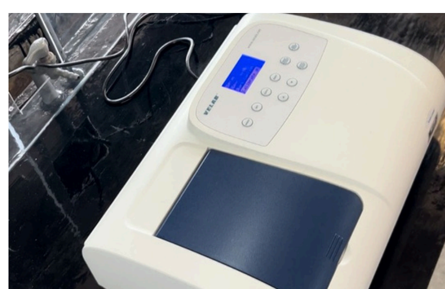
Figura 2. Espectrofotómetro VELAB VE-5100UV. Lab 3A.
