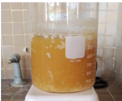
Figura 11. Procedimiento de recuperación de yoduro. Formación de precipitado de almidón.
