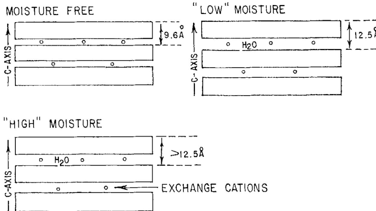
Cada capa de agua rígida (hinchamiento) incrementa el espesor de la celda unitaria de bentonita en 3 Å (12.6, 15.6 Å)
