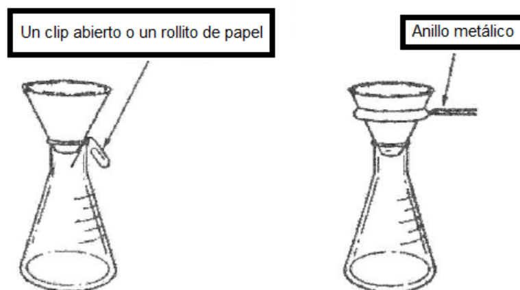
Figura 2. Maneras para crear un espacio entre el embudo y el matraz para que “respire” el sistema al filtrar.
