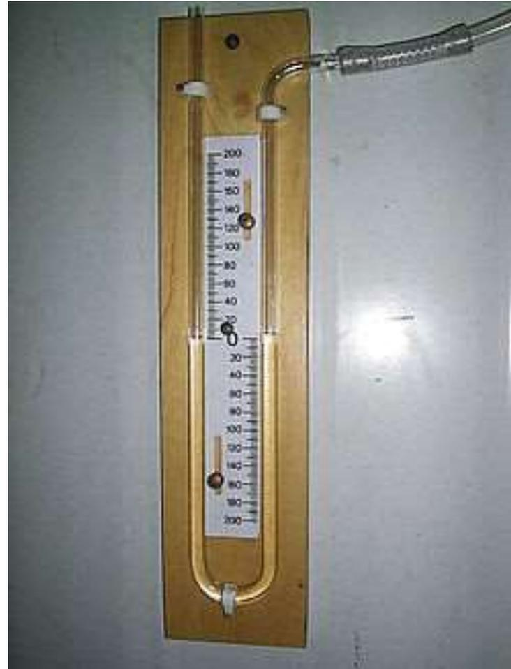
Manómetro diferencial de inspección que compara diferencia de **presiones estáticas** entre dos cámaras graduado en mm.c.d.a.
