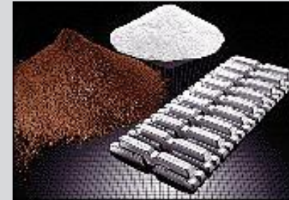
Materia prima ( \text{Al}_2\text{O}_3 ) y producto final (Al)
