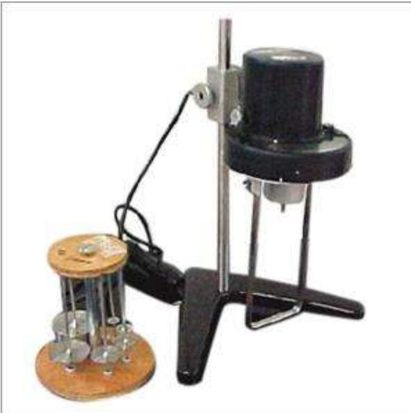
Si el cilindro interior rota dentro del líquido a ciertas revoluciones por minuto (RPM) a este movimiento se opone una fuerza que actúa sobre las paredes del cilindro.
