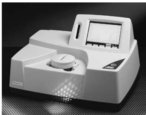
FIGURA 16.6 Fotografía de un espectrómetro sencillo IR de transformada de Fourier que se puede colocar sobre una mesa, por lo que es adecuado para estudiantes. Los espectros se registran en tan sólo unos segundos y se despliegan sobre la pantalla de cristal líquido para observarlos e interpretarlos. Los espectros se pueden almacenar en una tarjeta de memoria para examinarlos y analizarlos después, pero también se pueden imprimir. (Cortesía de Thermo Electron Corp., Madison, WI.)
