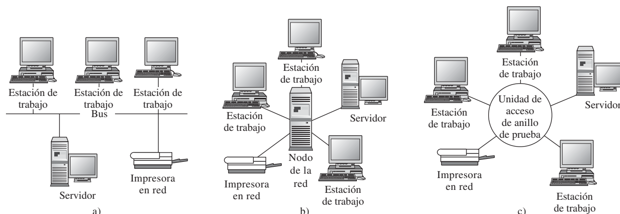
FIGURA 4.20 Disposición de las redes. En a) se ilustra la disposición con bus. En este caso, las computadoras se comunican mediante un largo bus. Se requiere instalar programas en todos los dispositivos para que haya comunicación. En b) se muestra la disposición en estrella. Aquí, las computadoras se conectan entre sí mediante una caja de enlace o nodo de acceso. En c) se presenta el acomodo en anillo de prueba. La información circula en un anillo alrededor de la red.
