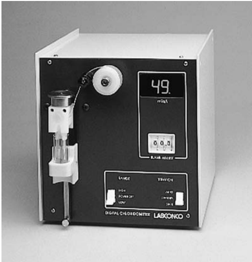
FIGURA 24.11 Medidor de cloro digital comercial. Este titulador coulombimétrico está diseñado para determinar el ion cloruro en muestras clínicas como suero, orina y sudor. Se utiliza en el diagnóstico de fibrosis quística. El medidor también se usa en laboratorios ambientales. (Cortesía de Labconco Corp., Kansas City, MO.)
