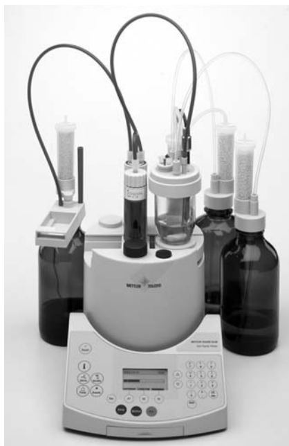
FIGURA 24.8 Titulador coulombimétrico automatizado. Una computadora interna controla todas las funciones del instrumento y los resultados de las determinaciones aparecen en la pantalla de cristal líquido. (Cortesía de Mettler-Toledo, Inc., Columbus, OH.)
