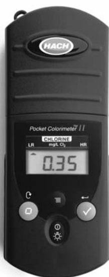
FIGURA 13.17 Fotografía de un colorímetro sencillo con diodos emisores de luz. (Hach Company, USA.)
