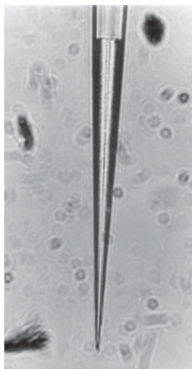
FIGURA 23.10 Fotografía de un microelectrodo intercambiador líquido de iones potasio (valinomicina) con 125 mm de intercambiador de iones en el interior de la punta. La ampliación de la fotografía original fue de 400×. (Tomado de J. L. Walker, Anal. Chem. , 1971 , 43 [3], p. 91A. Reproducido con autorización de la American Chemical Society.)
