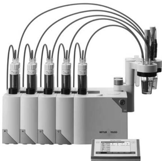
FIGURA 23.19 Titulador automático de alto rendimiento. Trabaja con hasta seis mecanismos impulsores para buretas, contiene programas de computación que el usuario puede modificar, permite una alta producción de muestras con un soporte giratorio para las mismas que no se muestra. El instrumento se puede adaptar para diversos tipos de titulaciones. (Copyright 2006 Mettler-Toledo, Inc.)
