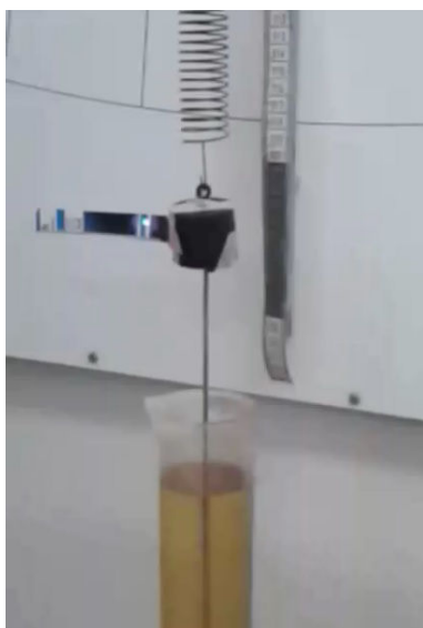
FIGURA 4. Sistema masa-resorte-amortiguador utilizado en este experimento.
