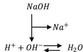
El monitoreo de la reacción anterior se realiza mediante un método conveniente para conocer el *Volumen de punto final* (v.p.f.) de la titulación, **en presencia de la resina**. Una vez que se obtiene dicho volumen, se puede conocer la Capacidad de Intercambio ( $C_I$ ) de la resina mediante la siguiente ecuación.
