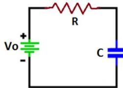
Figura 3. Representación de un circuito eléctrico RC en serie para cargar eléctricamente un capacitor.
