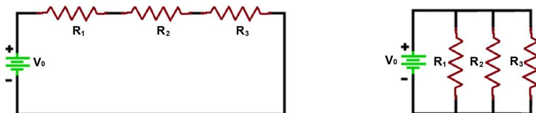
Figura 4. Diagrama de conexión de resistores en serie (parte izquierda) y paralelo (parte derecha).
