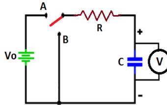
Figura 2. Circuito eléctrico RC en serie. La terminal A permite la carga del capacitor mientras que la terminal B la descarga del mismo.  $V_0$  representa la diferencia de potencial eléctrico de la fuente de alimentación, R al resistor y C al capacitor.
