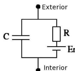
Figura 1. Esquema representativo de un circuito RC.
