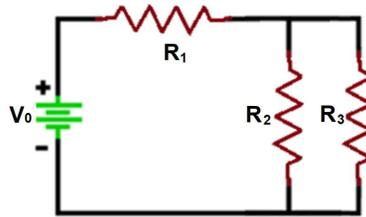
Figura 5. Diagrama de conexión de un circuito eléctrico con resistores en serie y paralelo.
