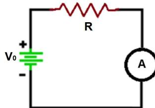
Figura 3. Diagrama de conexión de la fuente de alimentación y el multimedidor para medir la corriente eléctrica a través de un resistor.
