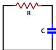
Figura 4. Representación de un circuito eléctrico RC en serie para descargar eléctricamente un capacitor.
