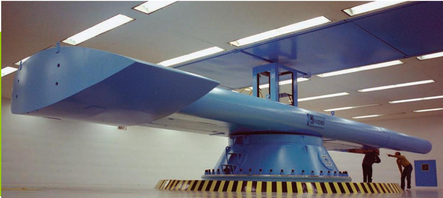
Gran centrifugadora empleada para probar el comportamiento de componentes de cohetes, satélites y vehículos de reingreso cuando se sujetan a altas aceleraciones. Gira a 175 revoluciones por minuto y genera una aceleración centrípeta de hasta  $300 \mathbf{g}$  (300 veces el valor de la aceleración gravitatoria).
