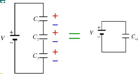
La batería produce una carga q igual en cada capacitor en serie, pues induce una carga positiva en la placa positiva de  $C_1$ , la cual induce una carga negativa en la placa opuesta of  $C_1$ ....
