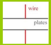
que recuerda las dos placas (plates) y los alambres (wire) o terminales conductoras.
