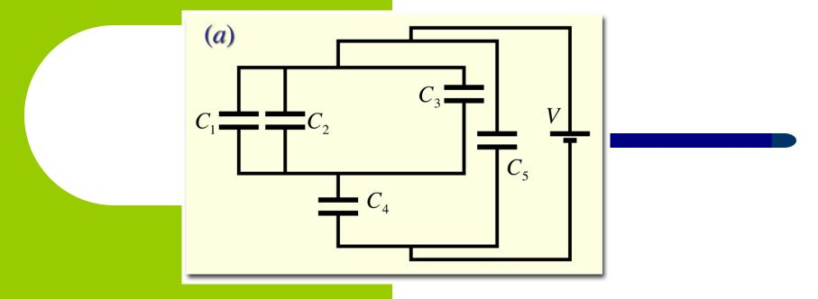
Si cada capacitor tiene una capacitancia de 5 nF, ¿cuál es la capacitancia del sistema de capacitores ó capacitancia equivalente?
