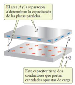
Capacitancia de un par de conductores
