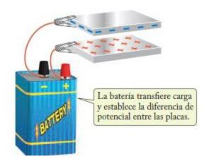
Un capacitor de placas paralelas conectado a las terminales de una batería
