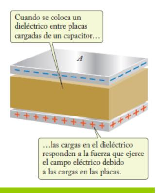
Una capa de dieléctrico entre las placas de un capacitor
