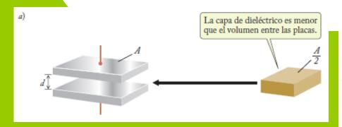
Un capacitor de placas paralelas de área A con una capa de dieléctrico que sólo tiene la mitad del área de las placas
