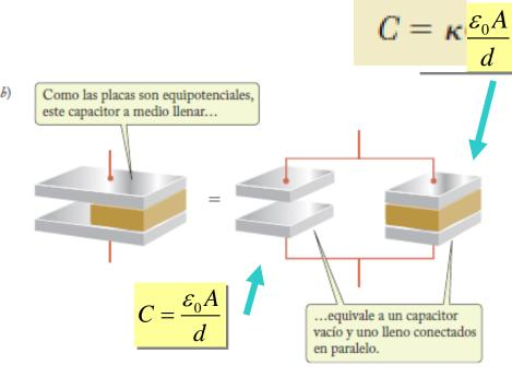
Circuito equivalente de capacitores
