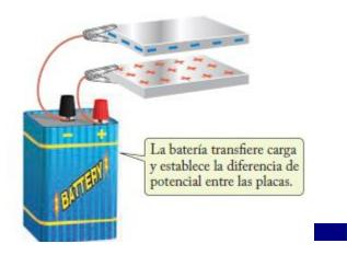
Un capacitor de dos conductores conectado a las terminales de una batería
