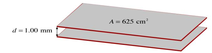
Se tiene un capacitor de placas paralelas construido a partir de dos placas planas de material conductor, cada una con un área de 625 cm<sup>2</sup> separadas por una distancia de 1.00 mm.
