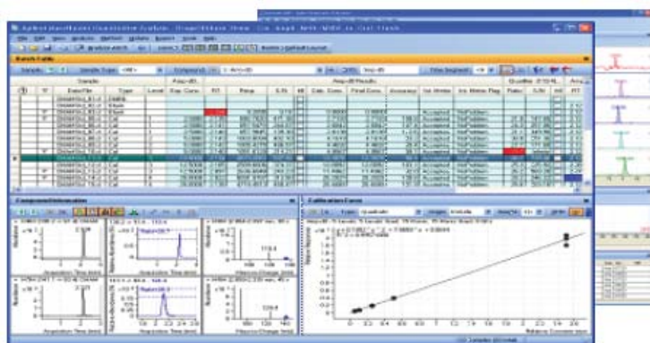
Eficaz análisis de datos MassHunter. El software MassHunter de Agilent incorpora el análisis avanzado de datos cuantitativos "Batch at a Glance", un integrador sin parámetros contrastado y fiable, así como otras herramientas para analizar datos de forma rápida y completa a partir de grandes grupos de muestras. Entre las herramientas de análisis cualitativo se incluye un nuevo editor de librería de espectros y rutinas de búsqueda. Las identificaciones pueden llevarse a cabo desde los datos Scan a través de un nuevo programa de deconvolución.
