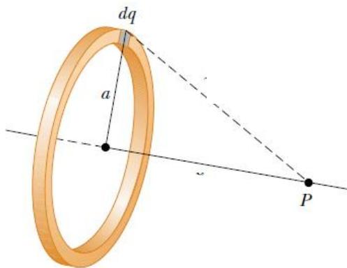
**Potencial electrostático debido a un anillo con carga uniforme**
