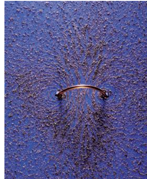
Líneas de campo magnético de un anillo de corriente, visibles con ayuda de limaduras de hierro
