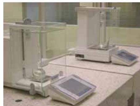
El método gravimétrico es un método primario para la medición de volumen
