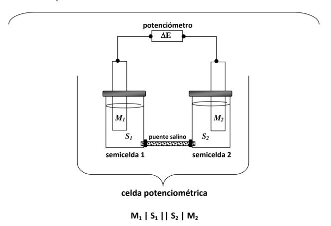
El puente salino esta constituido por una fase que permite contener solución iónica "atrapada" para que no se mezcle con  $S_1$  y  $S_2$  pero que permita cerrar el circuito eléctrico.
