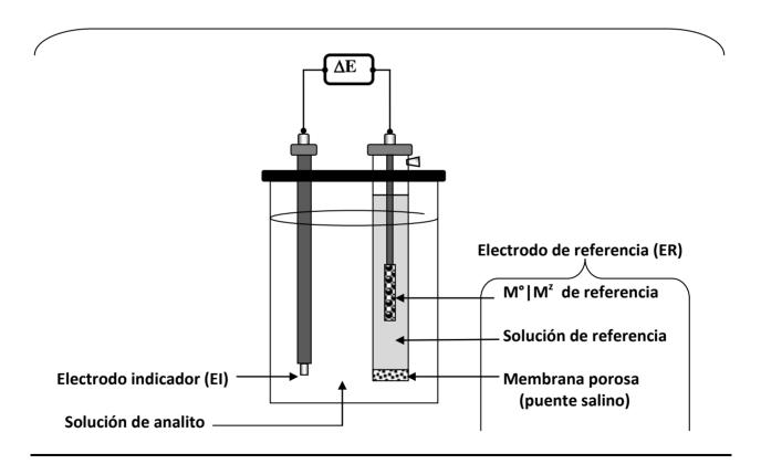
La membrana porosa puede ser fibra de algodón, yeso poroso, vidrio poroso cuyos poros son controlado en su tamaño a nivel iónico, a base de cuarzo ("vikor"), agar con nitrato de potasio, punta de platino, empalme vidrio-vidrio esmerilado.
