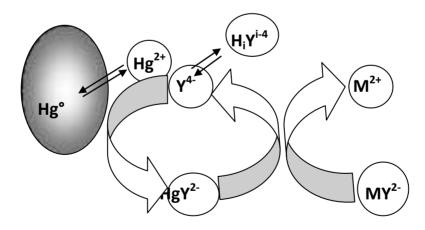
El pH del medio se controla en el intervalo de 2 < pH < 11 para evitar el predominio de los complejos hidróxido metálicos solubles e insolubles y se fija la fuerza iónica con una sal inerte conveniente. Primero se fija una concentración limitante de  $C_{Hg}$  y  $C_Y > C_{Hg}$ , posteriormente se introduce el catión  $M^{z+}$  en estudio. El potencial medido viene dado por la ecuación de Nernst-Peters siguiente:
