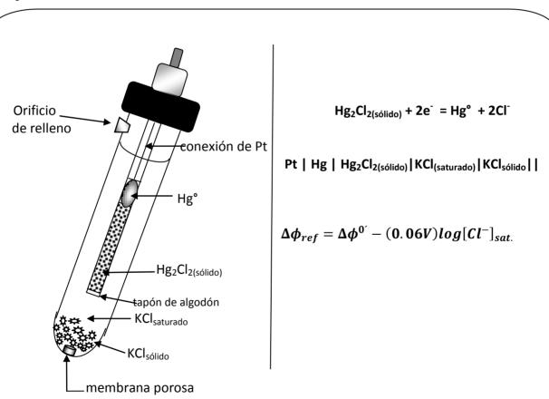
Comercialmente estos electrodos están diseñados para trabajar con volúmenes grandes, V≥ 50 mL, en combinación con electrodos indicadores de igual tamaño. La pasta de calomel es muy frágil y puede secarse y fragmentarse fácilmente provocando mas contacto eléctrico.
