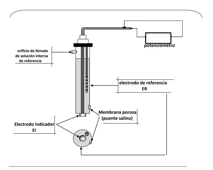
Estos electrodos ensamblados juntos se les conocen como "electrodo combinado".
