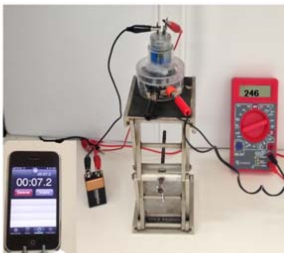
Fig. 5. Diseño instrumental terminado para la titulación microcoulombimétrica con indicador visual (el amperímetro es opcional)
