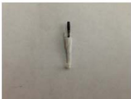
Fig. 6 Electrodo cubierto de papel absorbente para la compartimentalización del electrodo auxiliar (ánodo)
