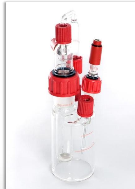
Figura 2: Celda coulombimétrica
