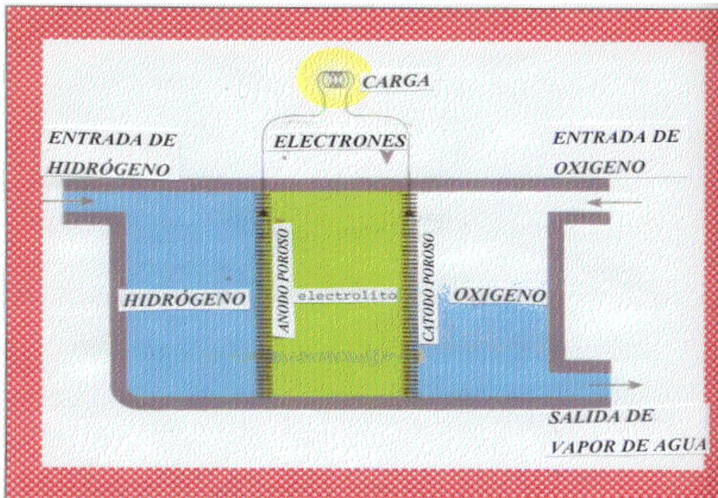
Este tipo de celdas de combustible ha sido ampliamente usada en naves espaciales y actualmente se investiga en automóviles:
