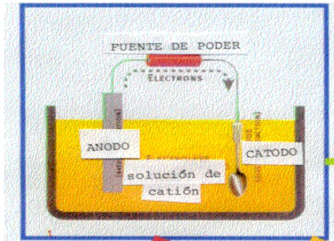
Actualmente es posible lograr electro-depósitos muy finos (del grosor de un cabello) que son usados en el armado de circuitos electrónicos en computadoras:
