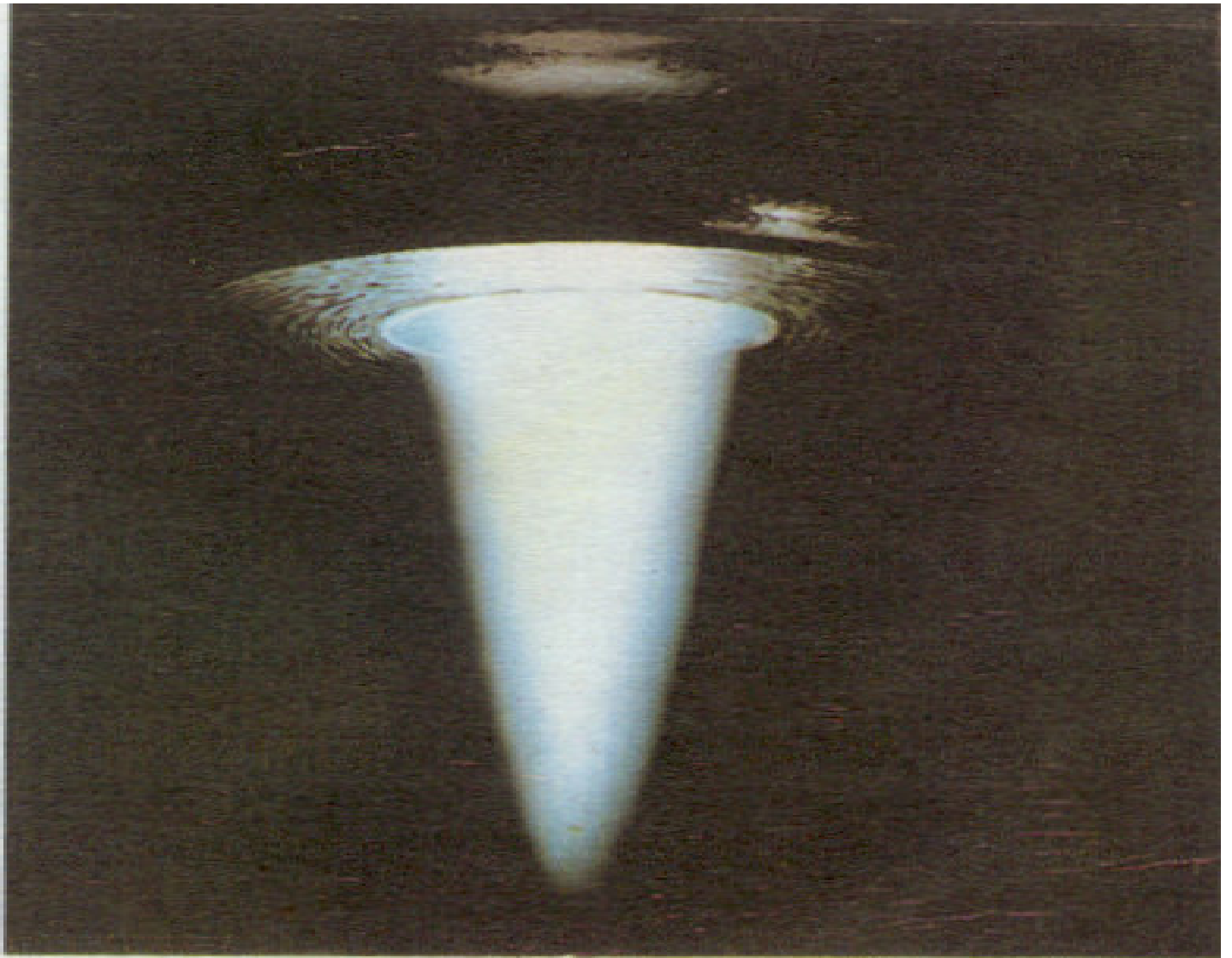
FIG. 4. Flujo de plasma frío que sale de la tobera de un plasmatrón.
