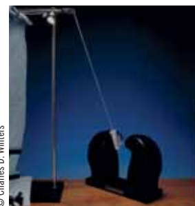
Un material paramagnético es atraído por un campo magnético
