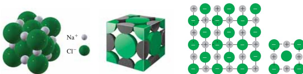
**Figura 13.28** Algunas representaciones de la estructura cristalina del cloruro de sodio,  $\text{NaCl}$ . Los iones sodio se muestran en gris y los iones cloruro en verde.
