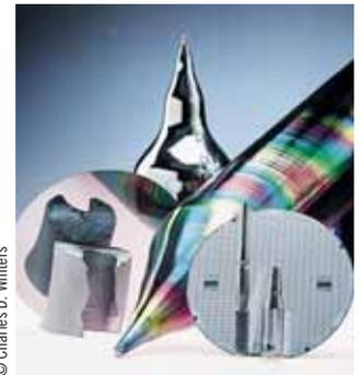
Varias muestras de silicio elemental. El círculo de la parte inferior derecha es un disco de silicio ultrapuro en el cual se han grabado muchos circuitos electrónicos.
