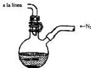
Figura 12.1. Dispositivo para la hidrogenación catalítica del estireno.
