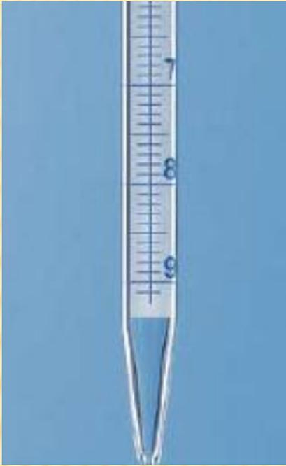
**Pipetas de vaciado total:** debe expulsarse todo el líquido para completar el volumen dispensado
