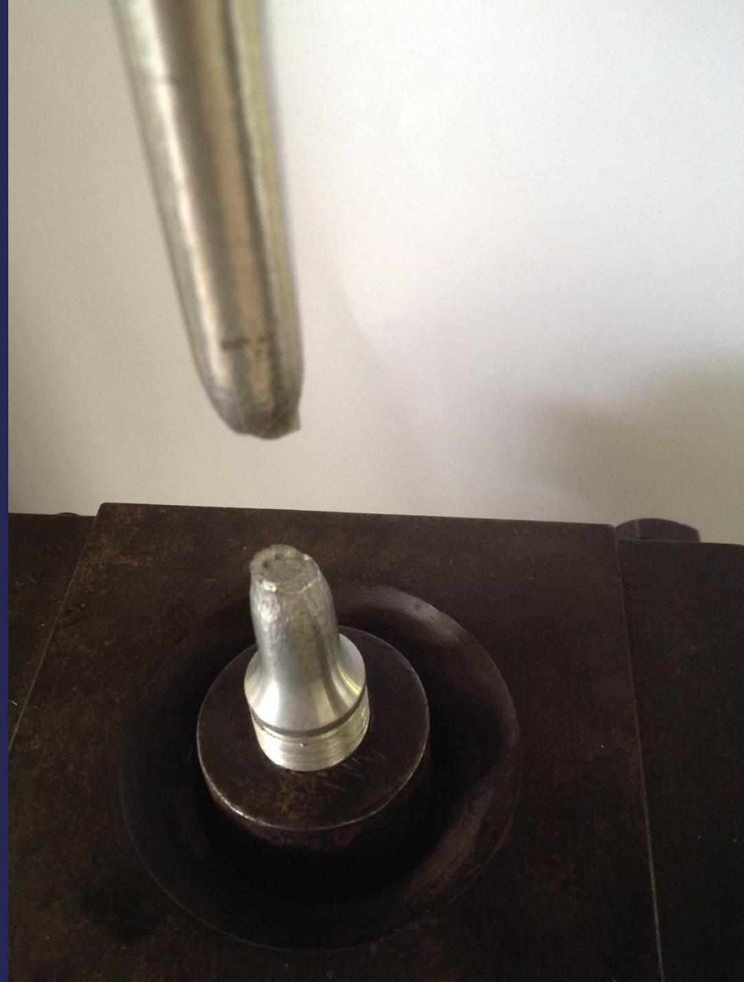
Veamos la carátula del equipo de "Ensayos universales" y la probeta de tensión.
