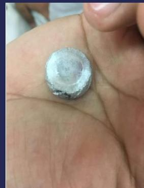
**En el caso del latón una vez efectuado el ensayo se deben unir las dos partes obtenidas para medir la altura final y el diámetro final de la probeta (en el caso del latón).**
