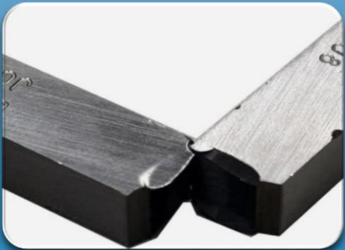
1. Conocerá el efecto de la temperatura en la energía absorbida en una probeta de impacto.
