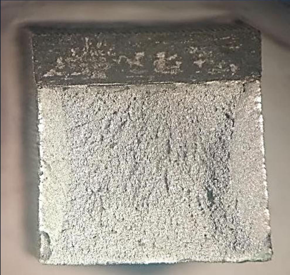
**En la frágil casi no se reduce el área, por lo que no se deforma el área de la fractura y la forma de la fractura es casi plana.**
