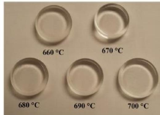
Uso de lubricante en la deformación de probetas de vidrio sometidas a un esfuerzo de compresión a temperaturas elevadas
