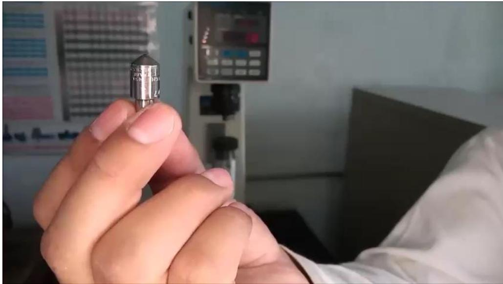
6.- Mida la dureza Rockwell de cada una de las probetas deformadas con la escala adecuada, típicamente Rockwell B.
