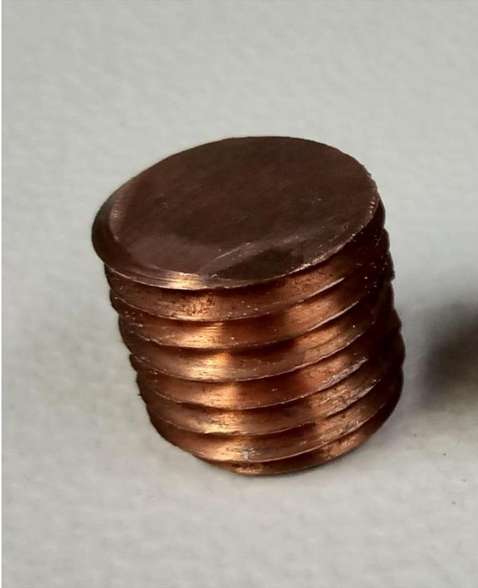
2.- Con ayuda de la lima y/o la lija de agua preparar la superficie de las probetas, de manera que ambas caras queden lo más perpendicularmente posibles, y que la superficie se encuentre lista para la toma de dureza Rockwell.
