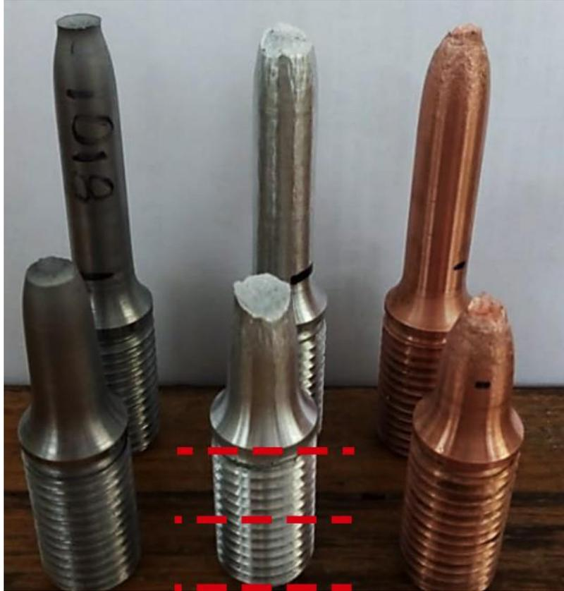
1.- Corte los extremos de las probetas de tensión utilizadas en la práctica “ensayo de tensión – ensayo de compresión”. De cada uno de los extremos se pueden obtener dos probetas cilíndrica con relación  $H/D$  aproximadamente igual a 1.
