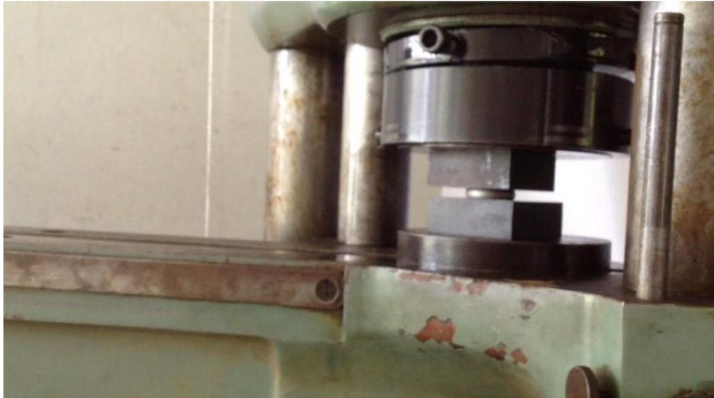
5.- Aplique la carga de compresión seleccionada a las probetas por medio de la máquina de tensión-compresión. Asegúrese de colocar tres o cuatro capas de lubricante en ambas caras de la probeta a ensayar con el fin de tener una deformación más uniforme.
