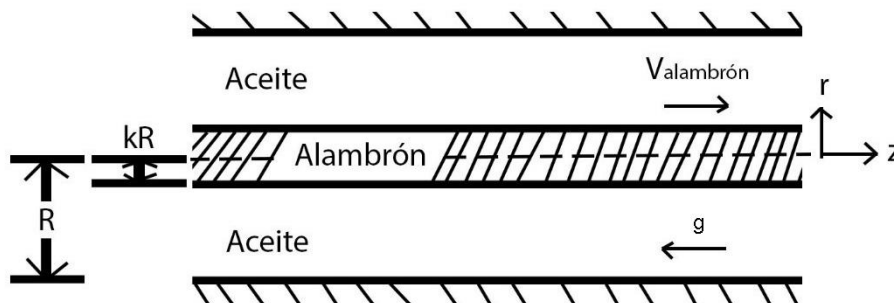
Figura 1.- Esquema del proceso para recubrir un alambón con una capa delgada de aceite.
