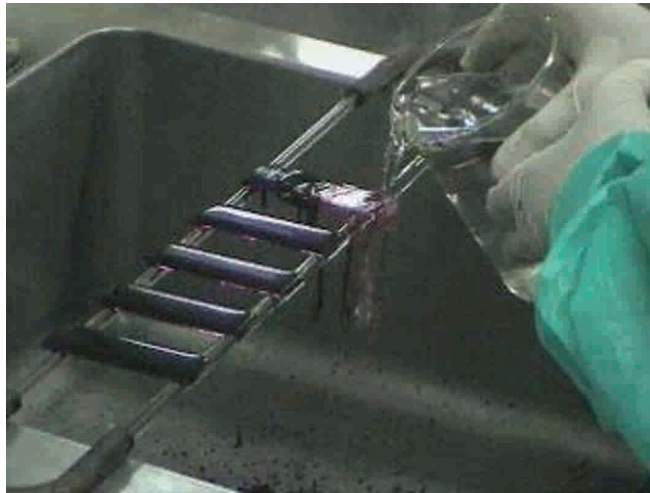
Figura 15. Lavado de las laminillas. El agua se vierte suavemente sobre la laminilla con el vaso de precipitado.
