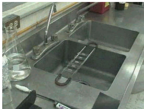
Figura 12. Disposición de frotis para tinción, sobre varillas de vidrio unidas en sus extremos con tubo de goma.
