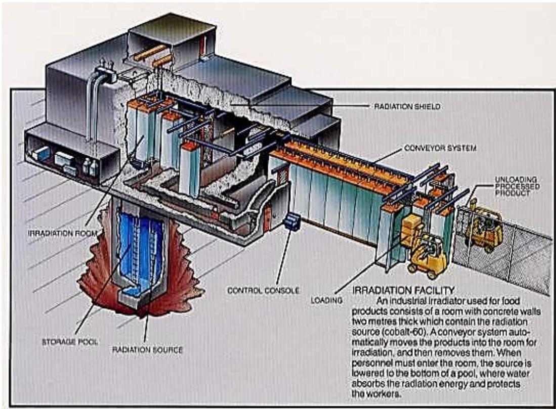
Los materiales se colocan en recipientes y contenedores que los llevarán a la cámara de irradiación. El proceso de transporte de material puede ser semiautomático o, automático pero sólo el material entra a la cámara por un sistema sin fin que introduce los contenedores por un lado y saca el material ya estéril por otro.
