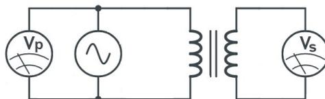
Figura 3. La bobina del lado izquierdo de la imagen corresponde a la bobina primaria por estar conectada a la fuente de alimentación de corriente eléctrica alterna mientras que la bobina del lado derecho de la imagen presenta la bobina secundaria en la que se inducirá una corriente eléctrica por efecto del campo magnético.
