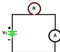
Figura 5. Diagrama de conexión de la fuente de alimentación y el multimedidor para medir la corriente eléctrica a través de la espira (resistor).
