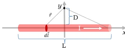
Figura 1. Alambre recto por el que fluye una intensidad de corriente eléctrica,  $I$ , generando un campo magnético en un punto distanciado una longitud  $D$  sobre el bisector.
