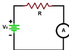
Figura 4. Diagrama de conexión de la fuente de alimentación y el multimedidor para medir la corriente eléctrica a través del segmento de alambre magneto (resistor).
