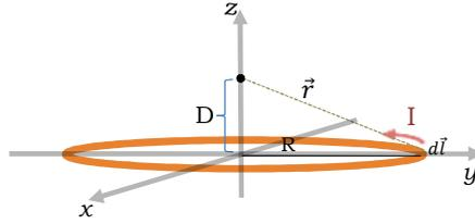
Figura 2. Espira circular por la que fluye una intensidad de corriente eléctrica,  $I$ , generando un campo magnético en un punto distanciado una longitud  $D$  sobre el eje perpendicular que cruza el centro de la espira.
