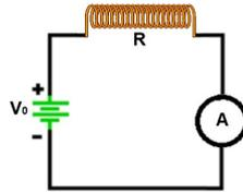
Figura 6. Diagrama de conexión de la fuente de alimentación y el multimetido para medir la corriente eléctrica a través del solenoide (resistor).
