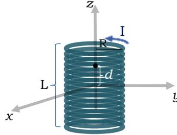
Figura 3. Solenoide por el que fluye una intensidad de corriente eléctrica,  $I$ , generando un campo magnético en un punto situado, sobre su eje principal, a una distancia  $D$  de su centro. El origen del sistema de referencia coincide con el centro del solenoide.
