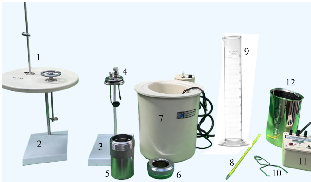
Figura 2.- Descripción del Calorímetro de Bomba de Oxígeno. 1.- Tapa con agitador del recipiente adiabático, 2.- Soporte de la tapa del recipiente adiabático, 3.- Soporte de la tapa de la celda de combustión, 4.- Tapa de la celda de combustión, 5.- Celda de combustión, 6.- Tapa roscada, 7.- Recipiente adiabático, 8.- Termómetro con resolución de 0.1°C, 9.- Probeta de un litro, 10.- Pinzas para transportar la celda de combustión, 11.- Unidad de ignición y 12.- Recipiente con paredes diatérmicas.
