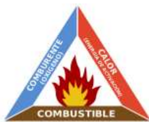
Figura 1. Esquema que muestra el triángulo de fuego de una reacción de combustión: combustible (sustancia rica en carbono susceptible de oxidarse), comburente (típicamente O_2 como agente oxidante) y la energía de activación (calor)
