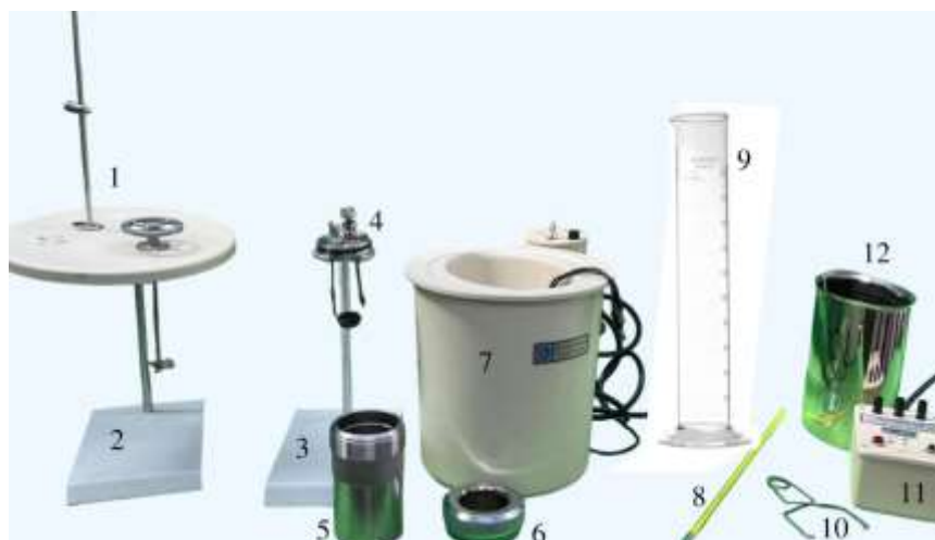
Figura 4. Fotografía que muestra el equipo y sus accesorios empleados en esta práctica: (1) tapa con agitador del recipiente adiabático; (2) soporte de la tapa del recipiente adiabático; (3) soporte de la tapa de la cámara de combustión; (4) tapa de la cámara de combustión; (5) cámara o celda de combustión; (6) tapa roscada; (7) recipiente o camisa adiabática; (8) termómetro de columna de Hg con resolución de 0.01^\circ\text{C} ; (9) probeta de 1000 mL; (10) pinzas para el transporte de la cámara o celda de combustión; (11) unidad de ignición y (12) cubeta de acero inoxidable.
