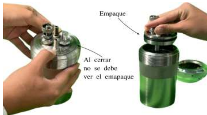
Figura 6. Fotografía que muestra el detalle de la verificación de la colocación de la tapa de la cámara de combustión en donde se aprecia que al introducir y empujar esta en el cilindro, el empaque de neopreno o-ring ya no se observa, lo que indica que fue colocado correctamente.
