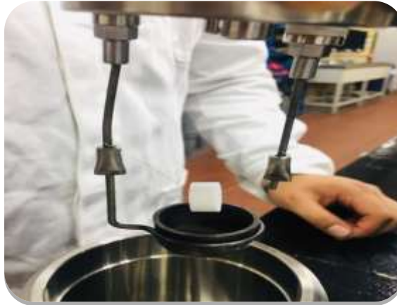
Figura 5. Fotografía que muestra la colocación de la pastilla de ácido benzoico con el alambre de ignición en los electrodos de la tapa de la cámara de combustión.
