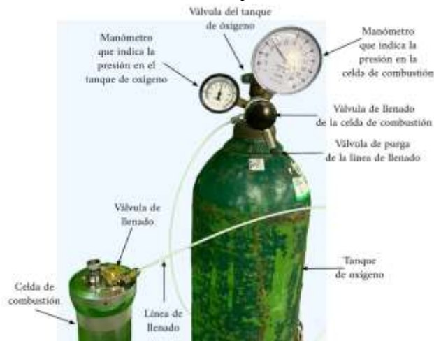
Figura 7. Fotografía que muestra la carga de oxígeno de la cámara de combustión.
