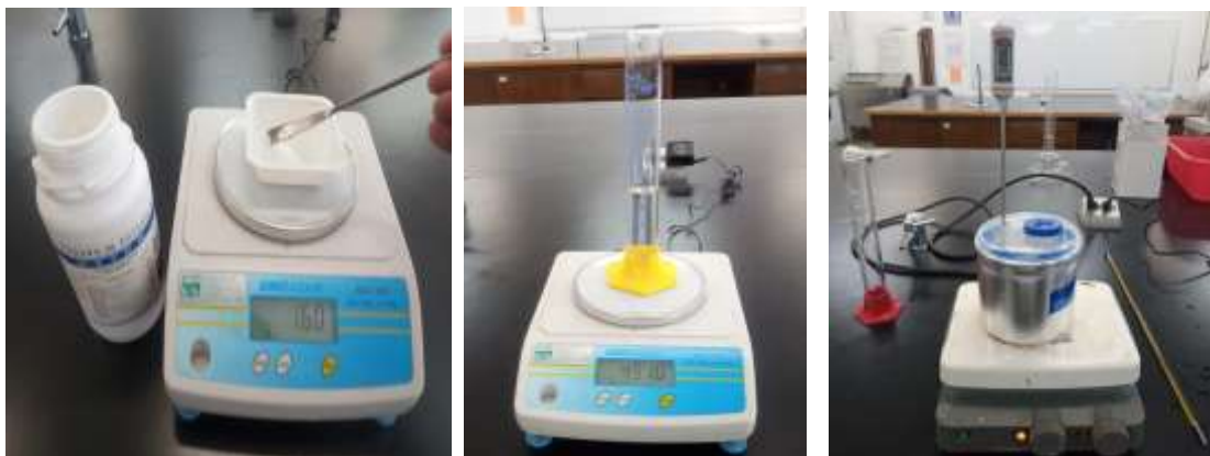
Figura 3. Fotografías que muestran de izquierda a derecha: (a) medición de la masa de sal; (b) medición de la masa de agua; (c) montaje experimental para la medición del cambio de temperatura al interior del calorímetro, cuando se añade la masa agua a la masa de sal inorgánica.
